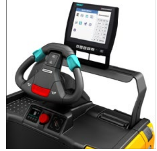
WMT 110 veri frekans terminalli opsiyonel askı (opsiyonel)
