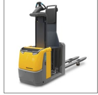
2. raf seviyesinden sipariş toplama için kaldırılabilir durma platformu (HP-LJ) (opsiyonel)
