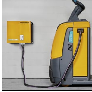
Lityum iyon akülerde konforlu yan şarj soketi (opsiyonel)
